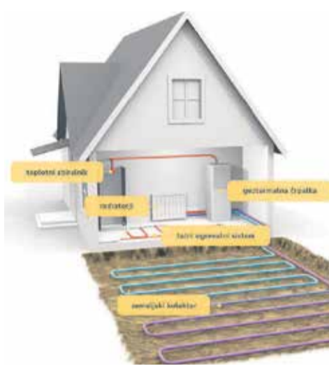
Sistem zemlja-voda / Zemeljski kolektor
